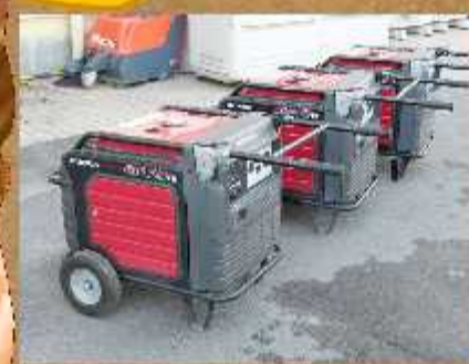
移動式発電機
